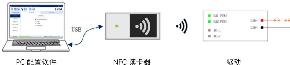
注：使用 NFC 读卡器，不允许驱动带电操作，驱动必须断电和完全放电后，才能正常读取和写入。
